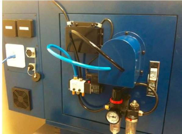
El regulador de presión automática.
